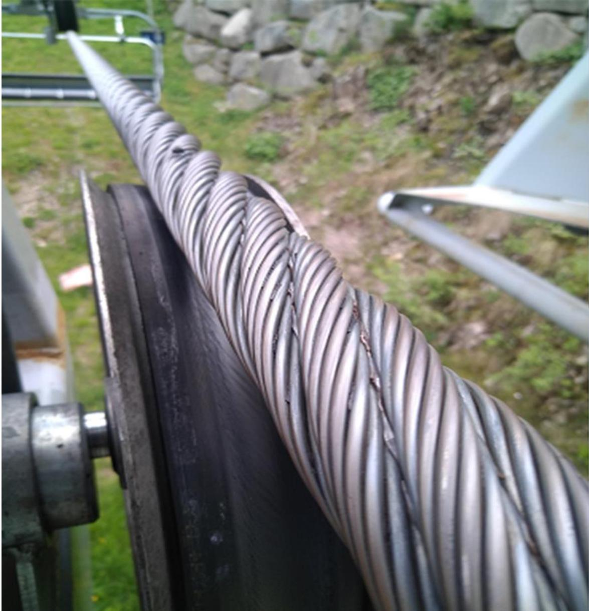
*Câble du télésiège de Vologne express (diamètre 46mm)*
