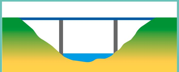
Un pont à poutre est un pont dont le tablier est porté par une ou plusieurs poutres en bois, en acier ou en béton armé. La structure peut être assimilée à une poutre droite.
